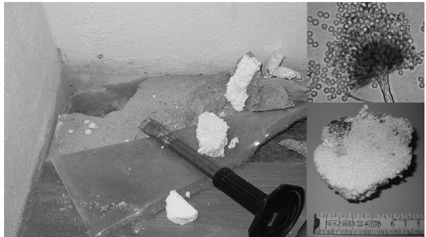
Bild 2. Materialprobenentnahme: Auf der verfärbten Polystyrol-Dämmung (unten rechts) war im konkreten Fall Aspergillus versicolor nachweisbar (oben rechts, stark vergrößert bei mikroskopischer Betrachtung).
